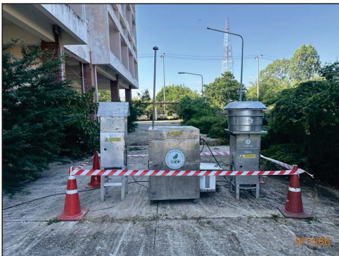
1 เครื่องตรวจวัดคุณภาพอากาศ (TSP, PM-10 และ CO)
